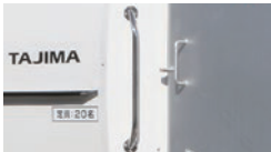
(6)乗降手すり(外側)
