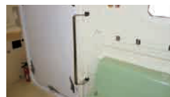
(24)乗降手すり(内側)
