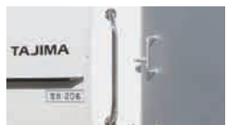
(6)乗降手すり(外側)
