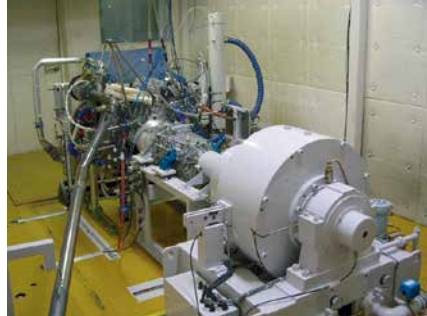
エンジンベンチ設備 動力計
