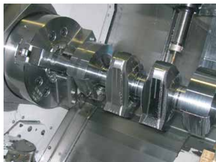
複合加工機による連続加工
