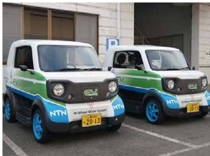
電気自動車コムーター「NTN超小型モビリティ」 ・後輪インホイールモーター (NTN製モーター) ・ナンバープレート取得、公道で実証実験を実施 ・磐田市公用車採用 伊勢市公用車採用 (NTN社向け開発車両)
