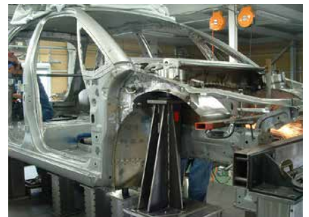
簡易定盤でのモノコックフレーム加工
