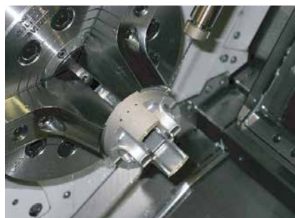
複合加工機による連続加工
