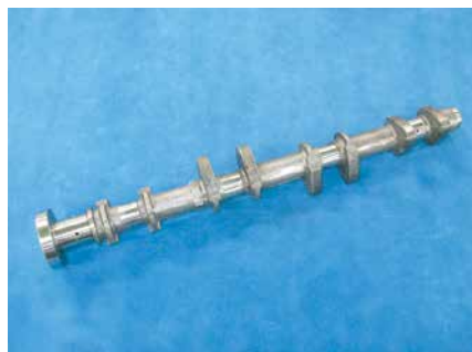
カムシャフト中間加工品 (プロファイル加工残し)
