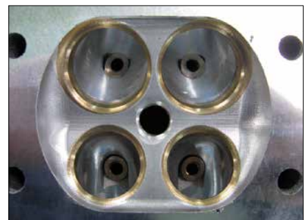
シリンダーヘッド 燃焼室加工
