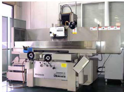
平面研削盤 Okamoto GRIND-X PSG84DX
