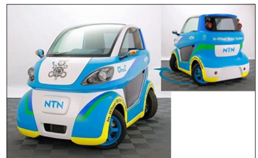
電気自動車コムーター「Qmo2」 ・4輪インホイールモーター ・平行移動、超信地旋回 可能 ・ナンバープレート取得、公道で実証実験を実施 (NTN社向け開発車両)
