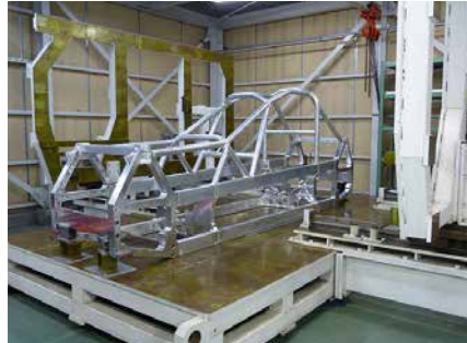
スペースフレーム製作（アルミ材）
