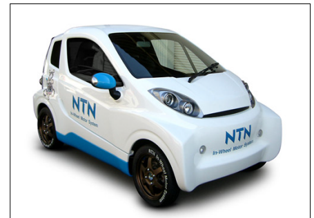
電気自動車コムーター ・後輪インホイールモーター ・ナンバープレート取得、公道で実証実験を実施 ・磐田市公用車採用 (NTN社向け開発車両)
