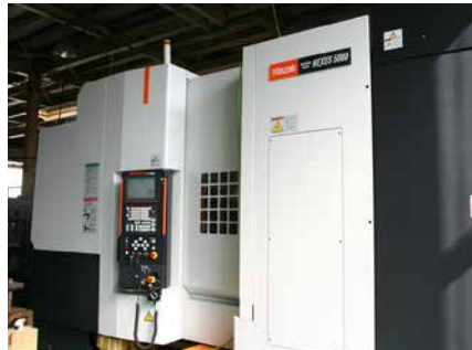
3軸横型マシニングセンタ Mazak NEXUS 5000
