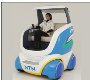
電気自動車コムーター「Qmo」 ・4輪インホイールモーター ・平行移動、超信地旋回 可能 (NTN社向け開発車両)
