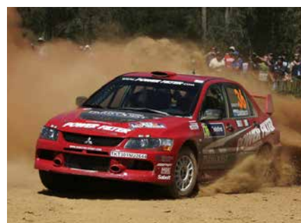
FIA プロダクションカー：ランサーEVO IX ・2000ccターボ ・4WD
