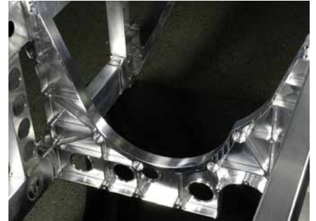
スペースフレーム製作（アルミ材）
