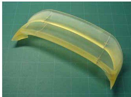
風洞モデル用リアウイング(樹脂光造形品)
