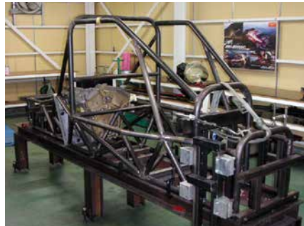
スペースフレーム製作（スチール材）
