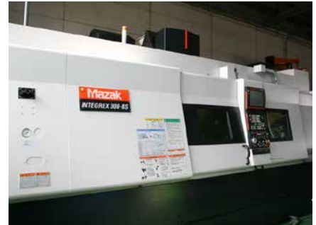
5軸複合加工機 Mazak INTEGREX 300-IIS
