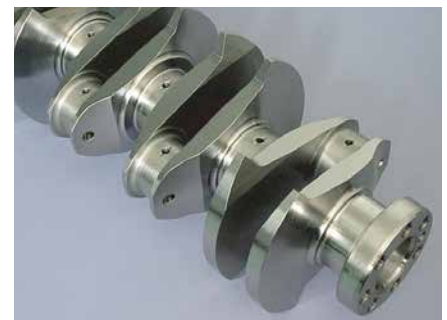
偏芯加工、油穴加工等マシニング工程の終了したクランクシャフト
