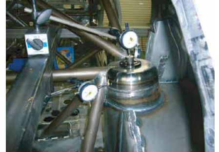
ねじり試験計測ポイント
