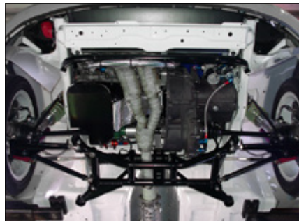
Super 1600 SWIFT マクファーソンストラット式 フロントサスペンション
