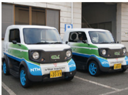
電気自動車通勤車「NTN超小型モビリティ」 ・後輪インホイールモーター(NTN製モーター) ・ナンバープレート取得、公道で実証実験を実施 ・磐田市公用車採用 伊勢市公用車採用 (NTN社向け開発車両)
