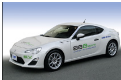
オンボードモーター 4モーター 四輪駆動 (SIM-Drive社向け開発車両)
