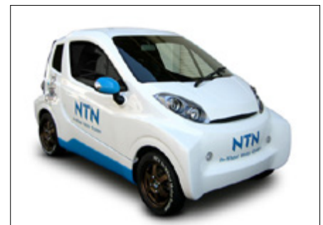
電気自動車通勤車 ・後輪インホイールモーター ・ナンバープレート取得、公道で実証実験を実施 ・磐田市公用車採用 (NTN社向け開発車両)
