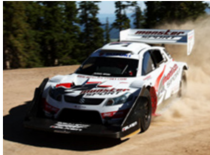
ヒルクライム専用車両: SX4 ・2700ccツインターボ ・4WD ・ミッドシップ/パイプフレーム
