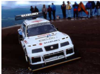
ヒルクライム専用車両: エスクード ・1600ccターボ(ツインエンジン) ・4WD ・パイプフレーム
