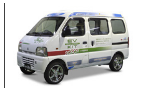
オンボードモーター 1モーター 後輪駆動
