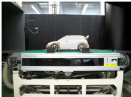
風洞実験装置(開放型測定部) 実車の走行状態を模擬するために必要なムービングベルト装置を装備しています。またムービングベルトにはターンテーブル機構も有します。
