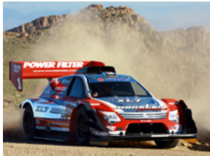
ヒルクライム専用車両: XL7 ・3600ccツインターボ ・4WD ・ミッドシップ/パイプフレーム
