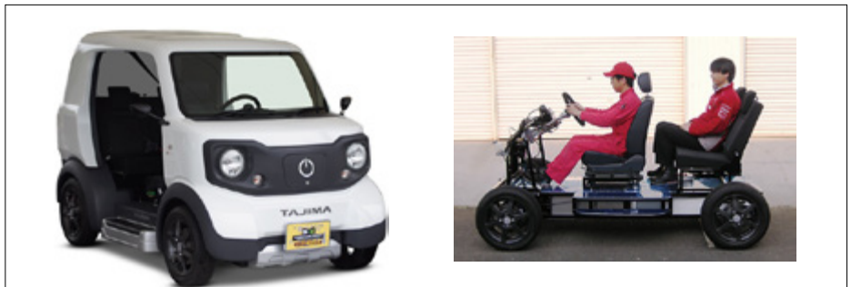
電気自動車通勤車 「TAJIMA超小型モビリティ プラットフォーム」 ・前輪オンボードモーター(TAJIMA製モーター)
