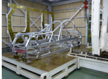
スペースフレーム製作（アルミ材）
