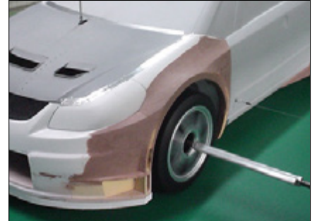
風洞実験を行いながらの形状検討
