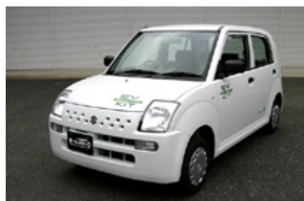
オンボードモーター 1モーター 前輪駆動
