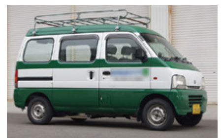
オンボードモーター 1モーター 四輪駆動 寒冷地対応車 (S社向け開発車両)
