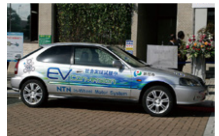
インホイールモーター 2モーター 後輪駆動 ・磐田市公用車採用 (NTN社向け開発車両)
