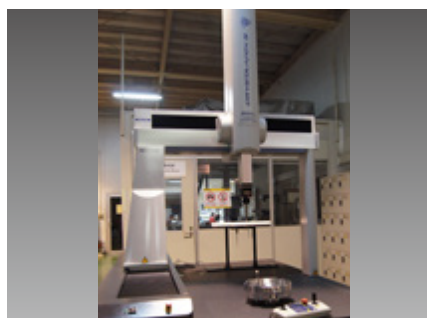
3次元測定機 Mitutoyo Crysta-Apex S9166
