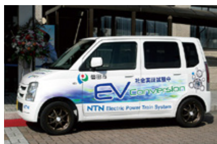
オンボードモーター 2モーター 前輪駆動 ・磐田市公用車採用 (NTN社向け開発車両)
