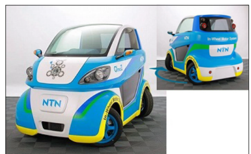
電気自動車通勤車「Qmo2」 ・4輪インホイールモーター ・平行移動、超信地旋回 可能 ・ナンバープレート取得、公道で実証実験を実施 (NTN社向け開発車両)
