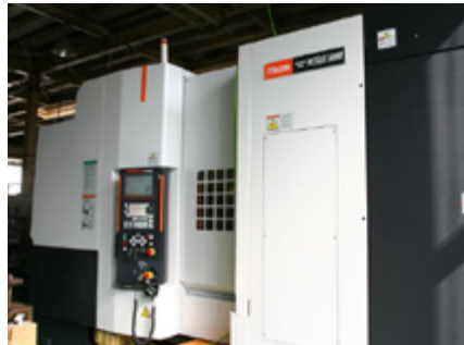
3軸横型マシニングセンタ Mazak NEXUS 5000
