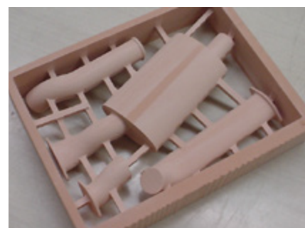
風洞モデル用エキゾーストパイプ(樹脂切削品)
