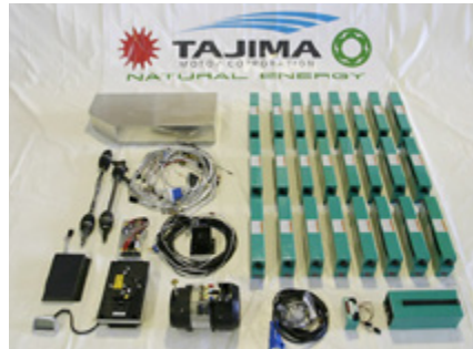
EV(電気自動車)コンバージョン用部品例 要求仕様に応じて、様々な駆動方式で製作することができます。 また、公道走行を可能にするため、ナンバー取得を行えます。
