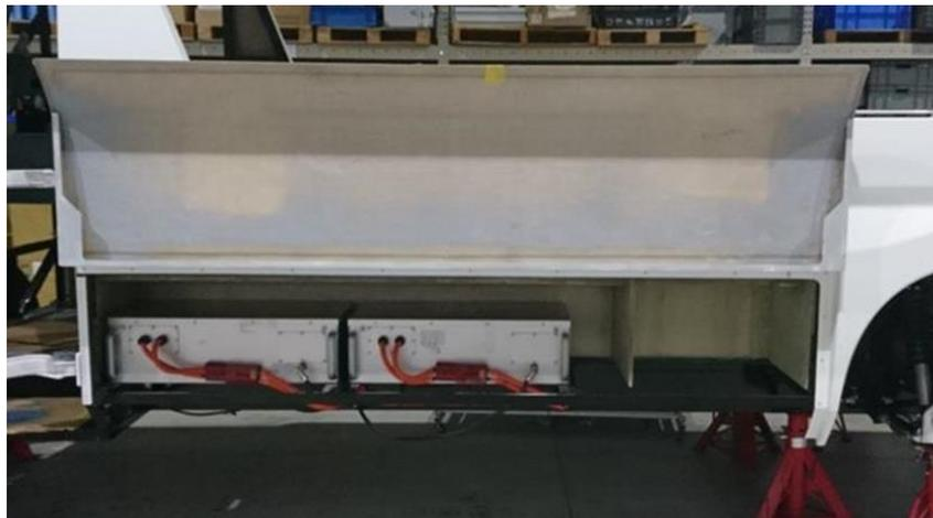
サイドハッチ(開き状態)と電池パックの搭載状況
