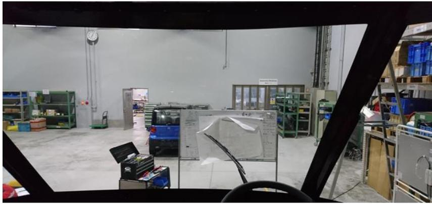
表面硬化ポリカーボネート製ウインドスクリーン (ドライバー視点からの写真)
