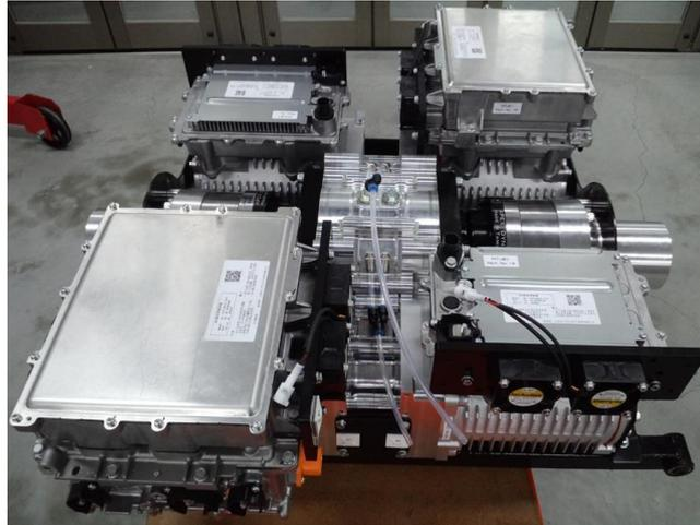
ギアボックスにより連結された4モータユニット これを前後に2ユニット搭載する
