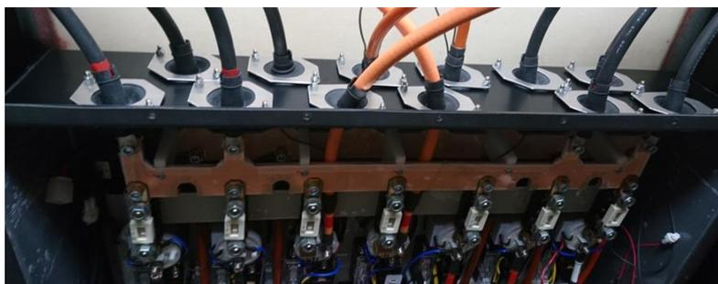
床下搭載状態の防水ジャンクションボックス(整備フタを開けた状態)
