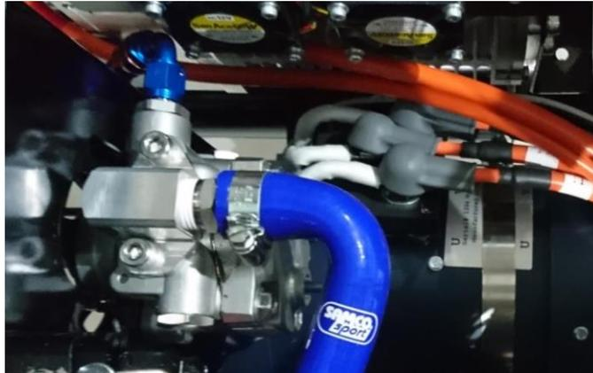
油圧ポンプ及び油圧配管、電動モータ及び配線
