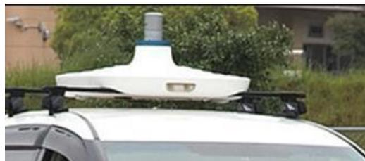
図 4-(5)-7 ティアフォー 自動運転システム(他社車両に搭載時の様子)
