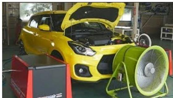
図 4-(5)-10 社内の設備による駆動力試験の様子
