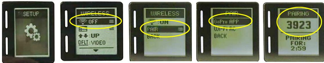
手順3: スマートフォン、タブレットのWi-FiをONにし、Captureアプリを新規立ち上げ、カメラを接続
